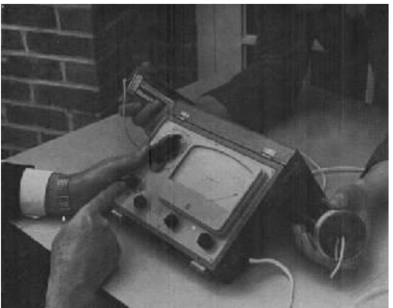
32. Quando terminar de usar o metro, desligue o botão da sensibilidade e ponha o botão "Set-Transit-Test" para "Transit". Isto evitara que as baterias se descarreguem e protege o mecanismo da agulha durante o transporte.
